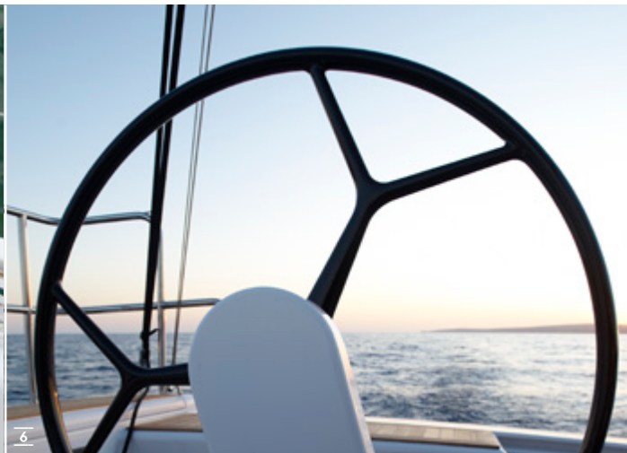
1 우현 방향 현창 2 넓직한 사이즈의 접이식 사다리를 갖춘 bathing platform 3 한층 더 안락하기 위한 소파 4 스테인리스강으로 된 접이식 티크 테이블(저장 공간 및 냉장고 포함) 5 르우마르 전자 윈치로 더욱 완벽한 제네이커 핸들링과 HANSE Crossover Sail 6 Y-spoke형 디자인으로 된 카보네이트 소재의 휠 7 러닝 데크와 콧핏의 우아한 표면 질감을 가진 합성티크와 천연티크, 8 다양한 컬러로 즐길수있는 넉넉한 잭과 크래들
